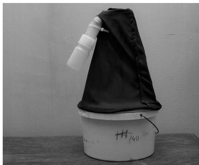
Fig. 1 - Mini-emergence trap / Mini trappola di emergenza per la cattura degli adulti
